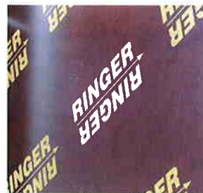
MASTER-Schalung Schalhaut ausgebaut, gereinigt, Ecken geschweißt
