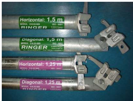
Diagonal- und Horizontalstreben mit farblich unterschiedlichen Längenaufklebern zur besseren Unterscheidung.
